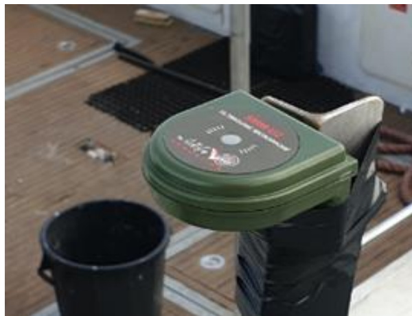
Rysunek 7.180. Mikrofon ultradźwiękowy SMM-U2 użyty podczas badań migracji jesiennej i wiosennej [Źródło: dane C-Wind Sp. z o.o.]
