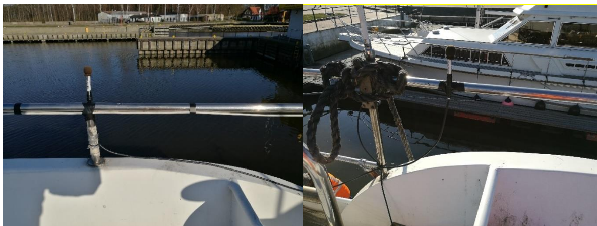
Rysunek 7.181. Umieszczenie mikrofonu na pokładzie radarowym jednostki Hydrocat 3 podczas kontroli [Źródło: dane C-Wind Sp. z o.o.]
