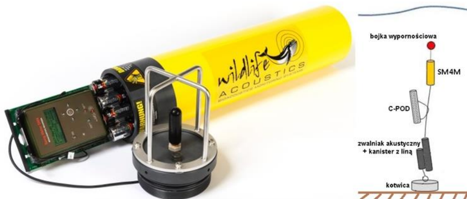
Rysunek 6.53. Rejestrator dźwięków SM4M Submersible (Wildlife Acoustics) wraz z hydrofonem HTI-96 (po lewej) oraz schemat posadowienia urządzenia pomiarowego w toni wodnej (po prawej) [Źródło: dane C-Wind Sp. z o.o.]
