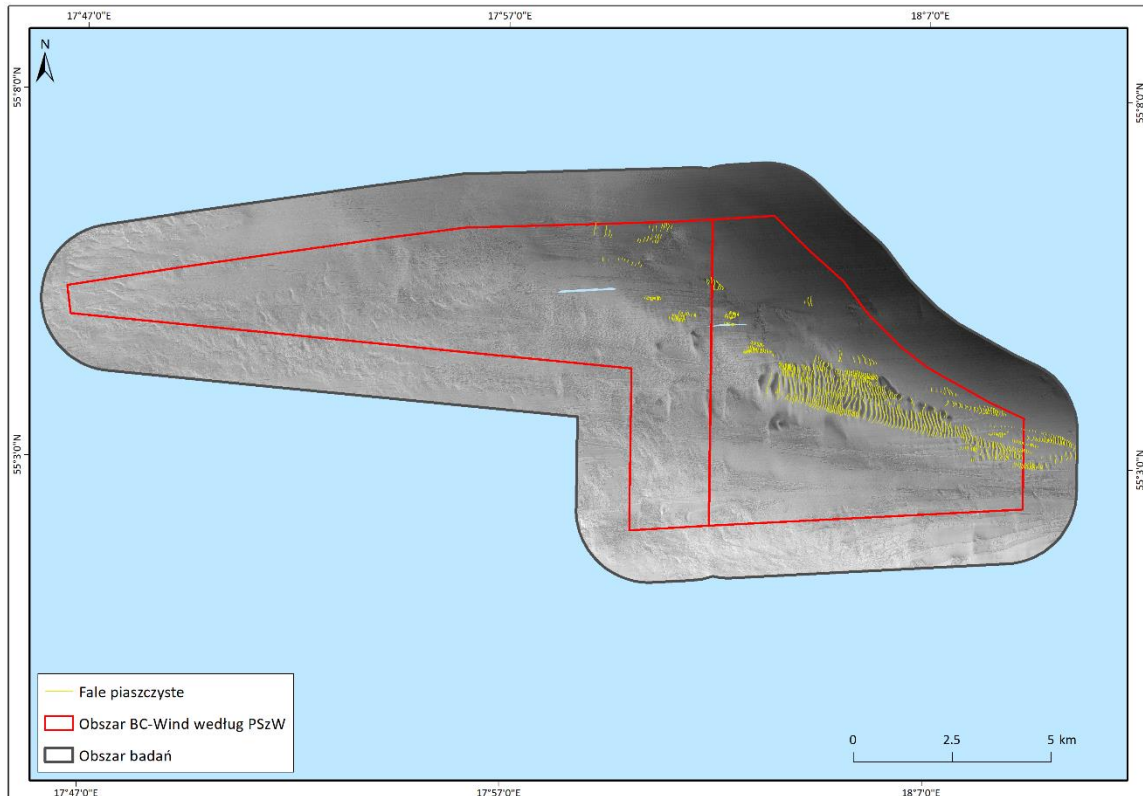
Rysunek 5.14. Mapa rozmieszczenia fal piaszczystych [Źródło: dane C-Wind Sp. z o.o.]
